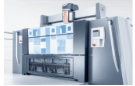
Simultaner Plattenwechsel mit AutoPlate XL bei gleichzeitigem Gummituch- und Druckzylinderwaschen.
