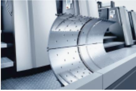
Venturi-Air-Jet-Technologie für kontaktfreien Bogentransfer nach der Wendung.
